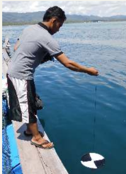
Pengukuran tingkat kecerahan dengan menggunakan secchi disk
